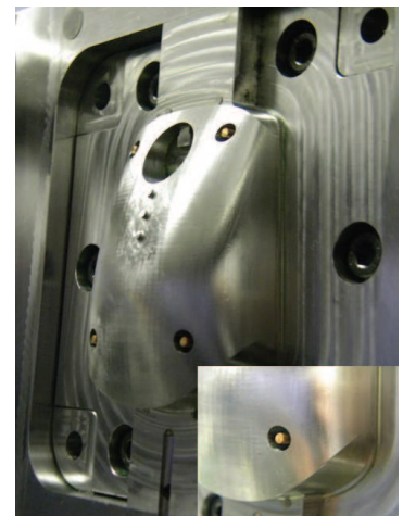
2. ábra. A réztötvözetű Knarr tűskék helyzete a szerszámban (hűtésük a lap mögött megtörtént) Szerszámgyártó: Mátyus és fia Kft.
